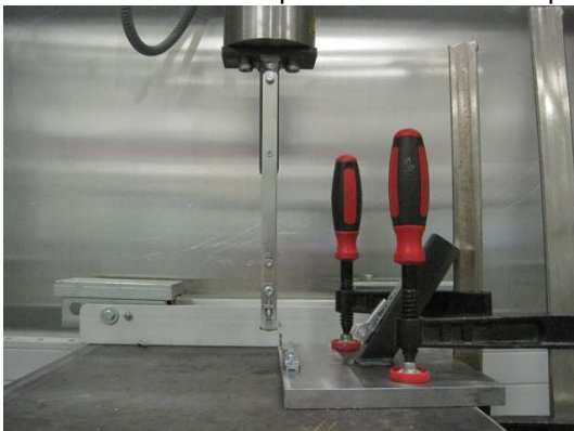
Bild 11 Mechanische Festigkeitsprüfung der Ecklager
