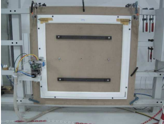
Bild 1 Ansicht Prüfkörper eingebaut in Prüfeinrichtung Dreh- Kipp
